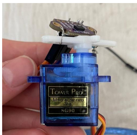
5.4-сурет – 0-ден 180 градусқа дейін бұрылуға арналған сервоқозғалтқыш
